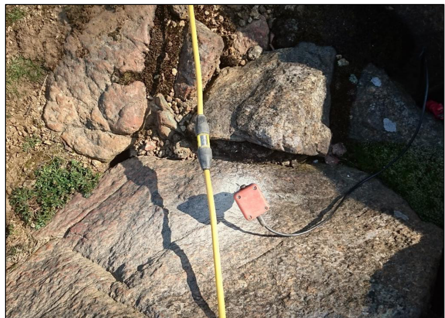
Posizionamento dei geofoni mediante preforo sui blocchi
